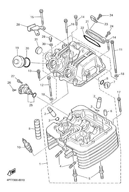
FIG. 1 CYLINDER HEAD
