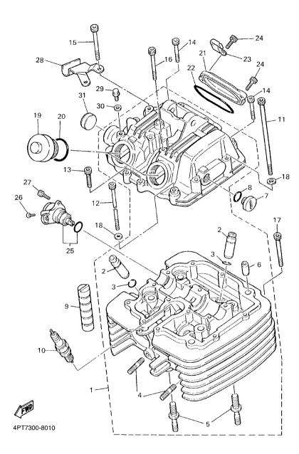
FIG. 1 CYLINDER HEAD
