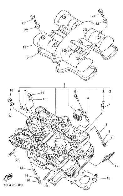
FIG. 1 CYLINDER HEAD
