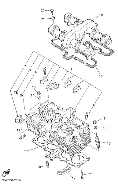
FIG. 1 CYLINDER HEAD
