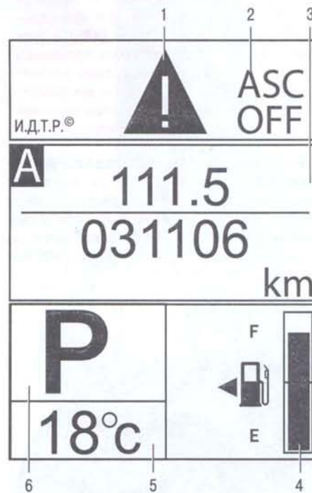
Рис. 1.10. Изображение на дисплее при включенном зажигании (на автомобилях с автоматической коробкой передач или бесступенчатым вариатором): 1 – символ, сигнализирующий о наличии предупреждающих сообщений; 2 – окно индикации системы курсовой устойчивости; 3 – информационное поле при включенном зажигании (см. табл. 1.5); 4 – индикация уровня топлива в баке; 5 – индикация температуры окружающего воздуха; 6 – индикация положения рычага селектора коробки передач
