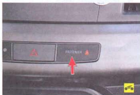
18 – сигнализатор непристегнутого ремнем безопасности переднего пассажира.
