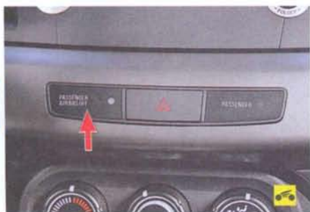
15 – сигнализатор отключения подушки безопасности переднего пассажира (см. «Средства пассивной безопасности автомобиля», с. 26).
