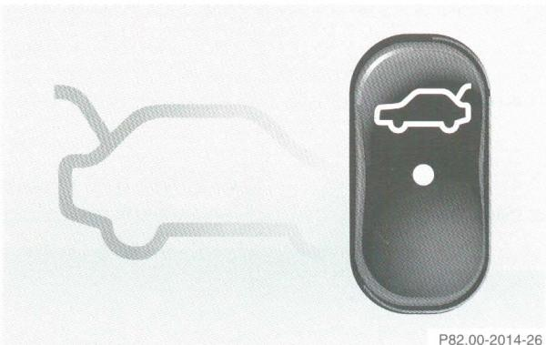
Включатель дистанционного открывания крышки багажника находится на средней консоли.
