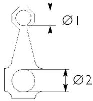
Ø1 = диаметр посадочного отверстия втулки верхней головки шатуна
