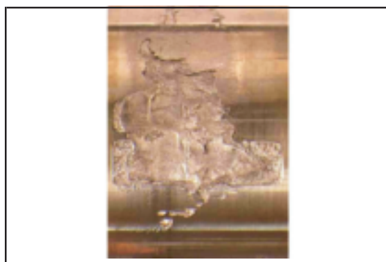
H. Macrospalling: Do Not Reuse
