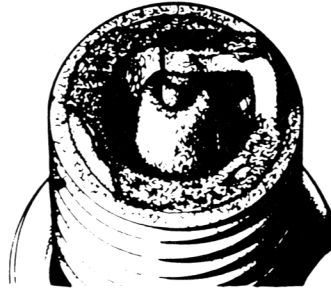
D Dicke Russablagerung, entweder infolge zu fetten Gemisches oder falschen Wärmewerts
