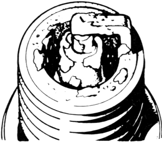
A Weiße Ablagerungen und beschädigter Isolator deuten auf Überhitzung hin
