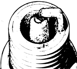
E Weiße Ablagerungen und abgebrannte Elektroden weisen auf zu mageres Gemisch hin
