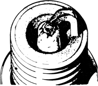
C Abgebrannte Elektroden, entweder infolge falschen Wärmewertes oder chronischer Frühzündung (Klingeln)
